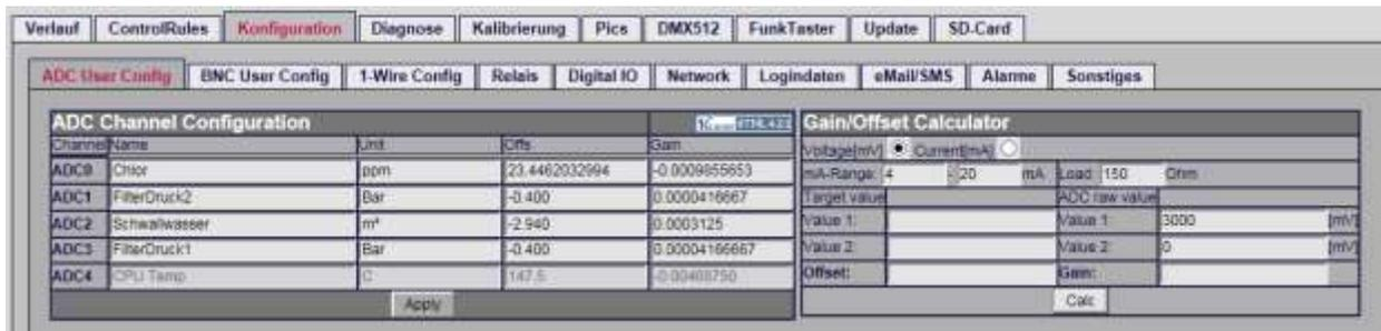
Abbildung 31: Konfiguration ADC Eingänge
