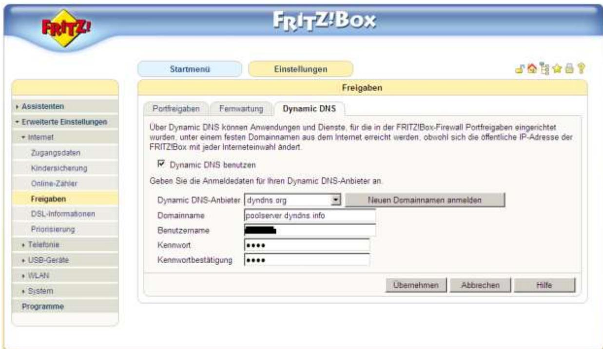
Abbildung 78: Konfiguration von Dynamic DNS
