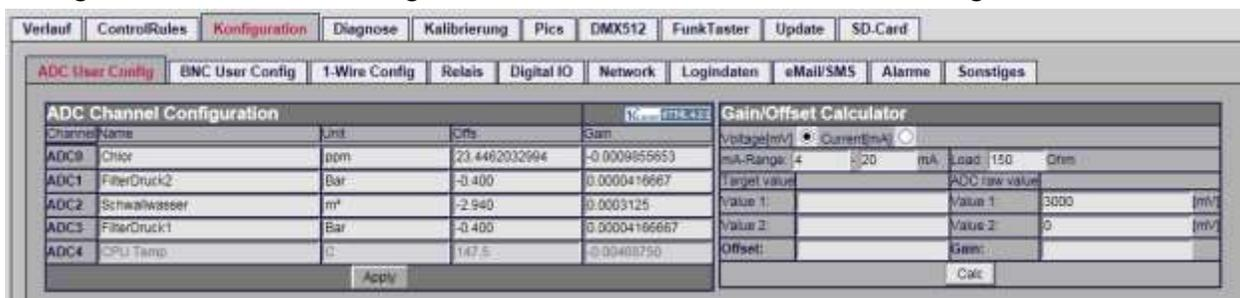
Abbildung 32: Beispiel: ADC Konfiguration 4..20mA Kesseldrucksensor (Filterdruck1 und 2)
