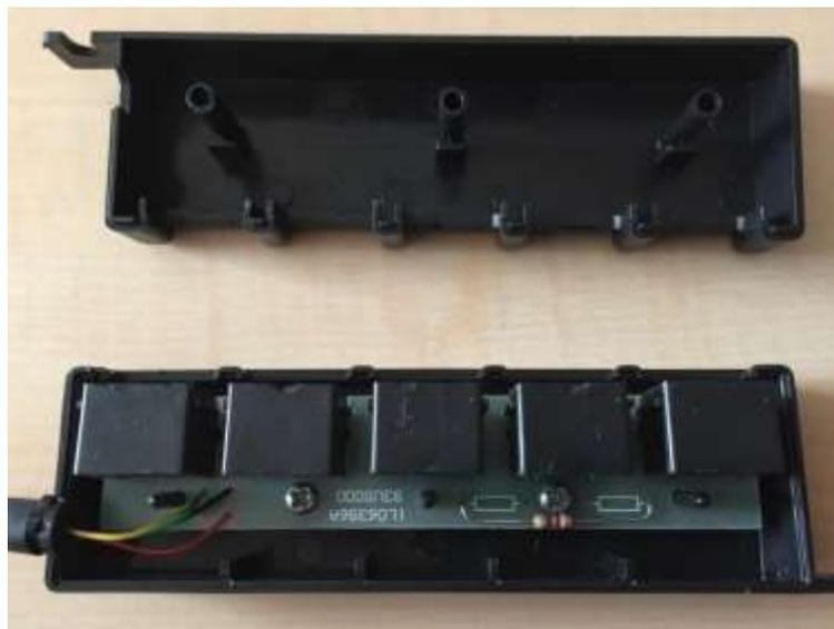
Abbildung 70: 1-Wire Verteiler, paralleler Widerstand, 4.7kOhm
