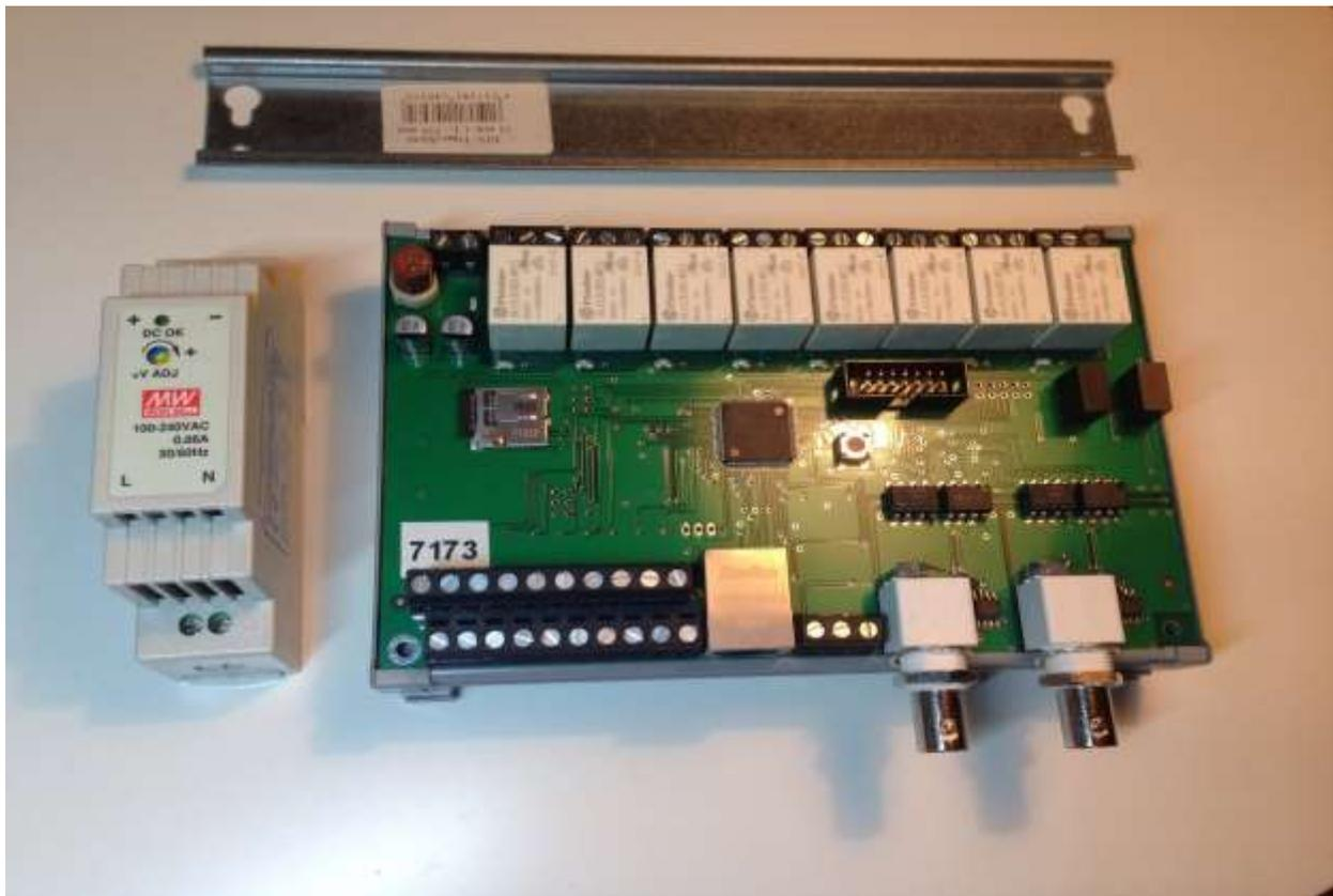
Abbildung 2: Hutschiene, Netzteil, Controller
